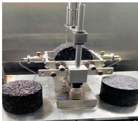
شکل ۵. آزمایش خستگی به روش کشش غیرمستقیم
