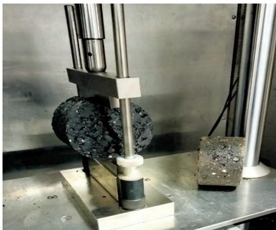
شکل ۴. آزمایش کشش غیرمستقیم لاتمن اصلاح شده
