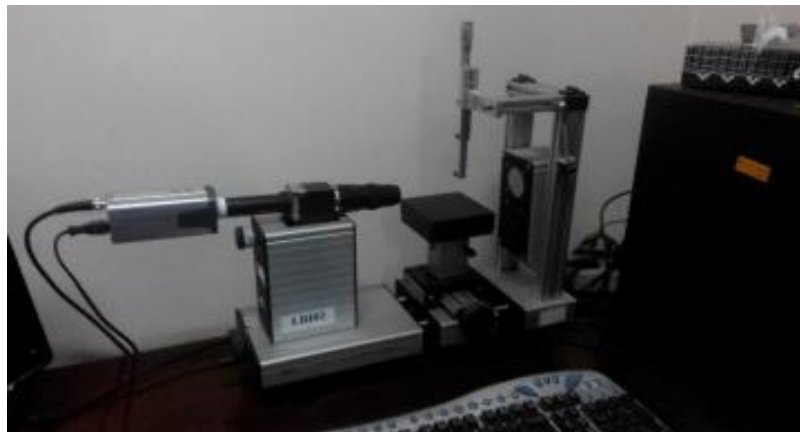
شکل ۷. دستگاه آزمایش قطره چسبنده
