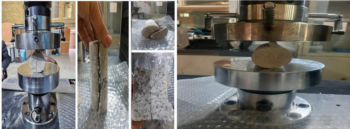
شکل ۱۳. آزمایش کشش غیرمستقیم: الف) نحوه‌ی قرارگیری نمونه جهت انجام آزمایش کشش غیرمستقیم و ب) تصاویر شکست نمونه حین انجام آزمایش و پس از آن
