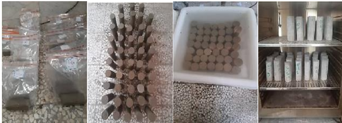
شکل ۷. مراحل انجام آزمایش دوام در برابر تر و خشک شدن: الف) عمل‌آوری نمونه‌ها، ب) خارج کردن نمونه‌ها از نایلون پس از طی دوره‌ی عمل‌آوری و قرارگیری در هوای آزاد، ج) غوطه‌ور نمودن نمونه‌ها در آب به مدت ۵ ساعت، و د) قرار دادن نمونه‌ها پس از برس‌زنی در گرمخانه در دمای 70 \pm 2 درجه‌ی سلسیوس به مدت ۴۲ ساعت
