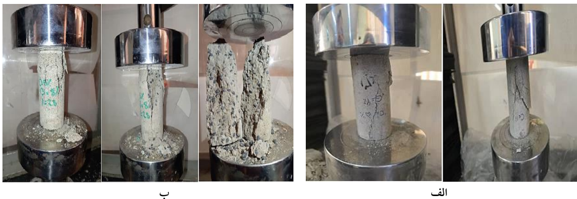
شکل ۱۲. نحوه‌ی شکست: الف) نمونه‌ی خاک-سیمان؛ و ب) نمونه‌ی خاک-سیمان-گرانول HDPE
