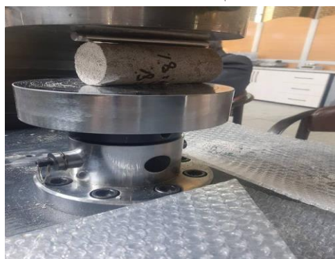
شکل ۶. تغییر ایجاد شده در دستگاه مقاومت فشاری برای انجام آزمایش مقاومت کششی غیرمستقیم، از زوایای مختلف
