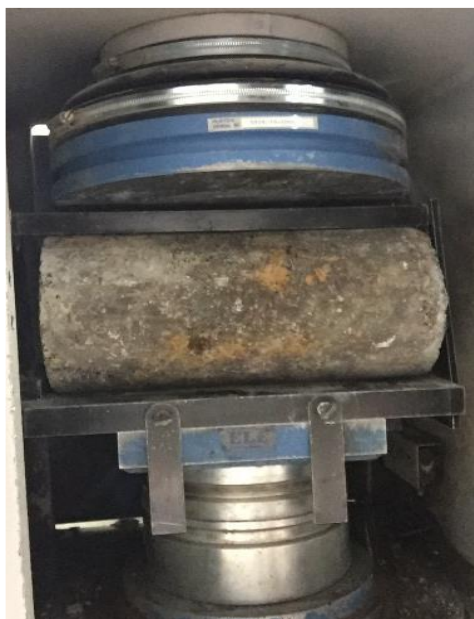
شکل ۱۳. نمونه و دستگاه اندازه‌گیری مقاومت کششی غیرمستقیم
