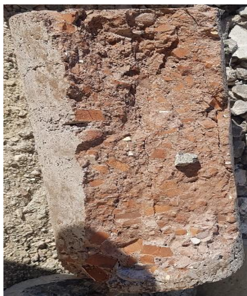
شکل ۱۸. نمونه شکسته شده تحت آزمایش مقاومت کششی
