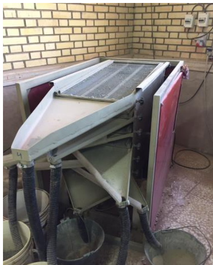
شکل ۴. دستگاه لرزاننده مورد استفاده برای دانه‌بندی مصالح درشت (شن)
