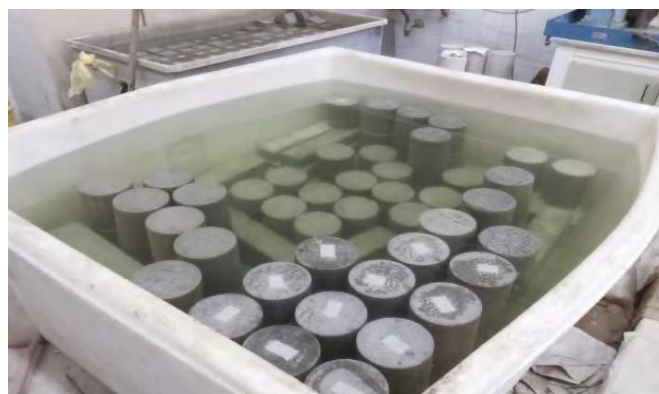
شکل ۱۲. عمل‌آوری نمونه‌ها در حوضچه
