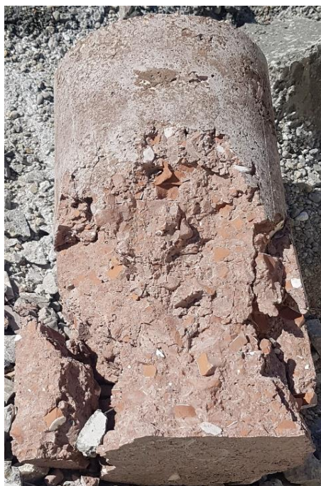
شکل ۱۶. نمونه شکسته شده تحت آزمایش مقاومت فشاری
