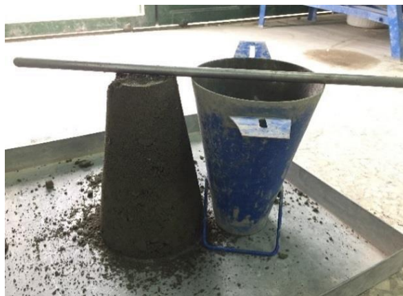
شکل ۱۰. دستگاه آزمایش روانی بتن
