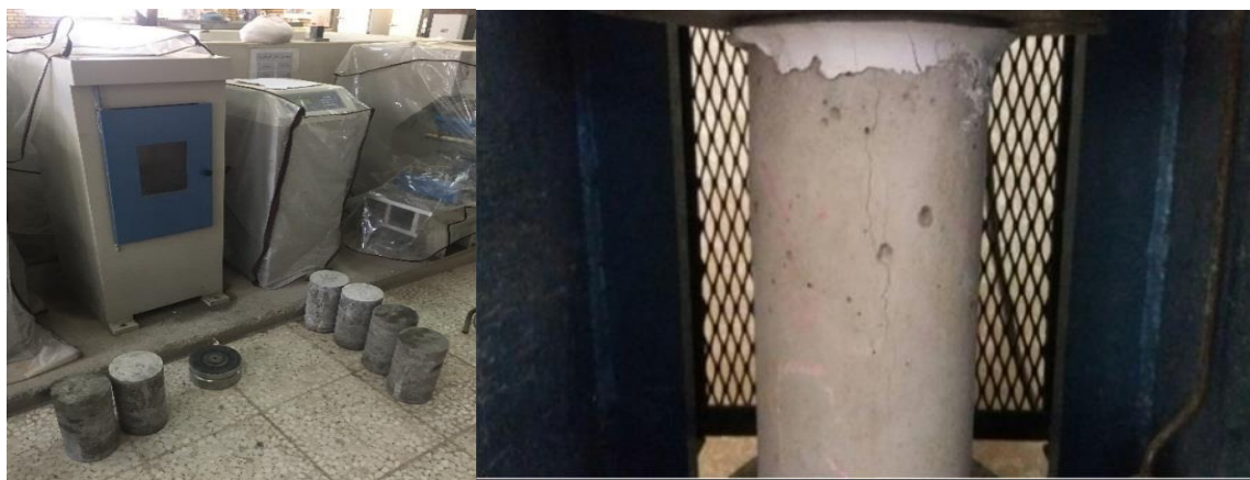
شکل ۱۱. نمونه و دستگاه اندازه‌گیری مقاومت فشاری
