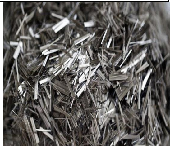
شکل ۲. تصویر الیاف بازالت مورد استفاده در این تحقیق
