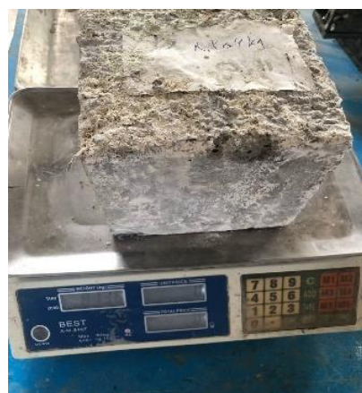
شکل ۷. نمونه تحت آزمایش جذب آب
