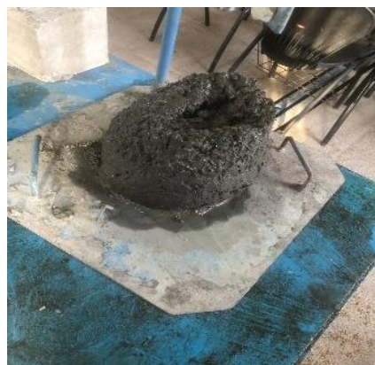
شکل ۴. آزمایش اسلامپ نمونه T4
