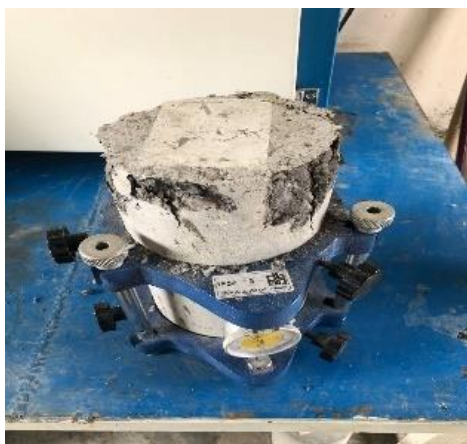
شکل ۸. نمونه تحت آزمایش مدول برجهنگی
