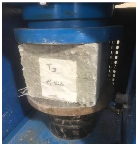
شکل ۵. نمونه طرح اختلاط T3 در زیر بار مقاومت فشاری
