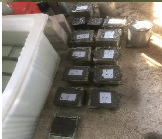
شکل ۳. نمونه های ساخته شده و در حال عمل آوری
