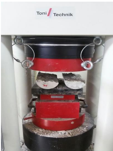
شکل ۳. آزمایش مقاومت کششی و نحوه‌ی قرارگیری
