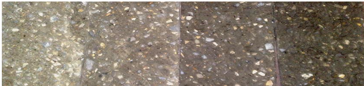
شکل ۱۶. افزایش تیرگی نمونه‌های بتن غلتکی با افزایش میزان پودر پسماند زغالسنگ
