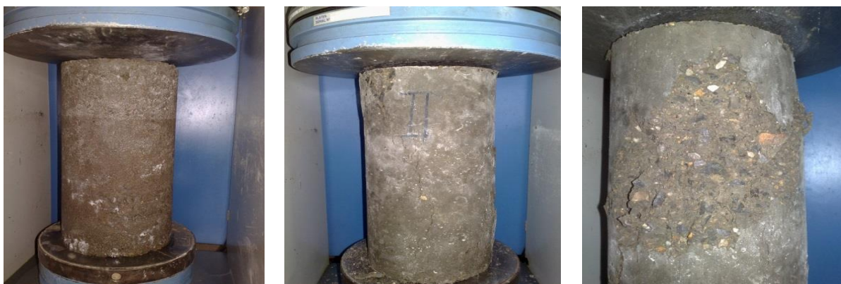
شکل ۷. نمونه بتن غلتکی پس از انجام آزمایش مقاومت فشاری
