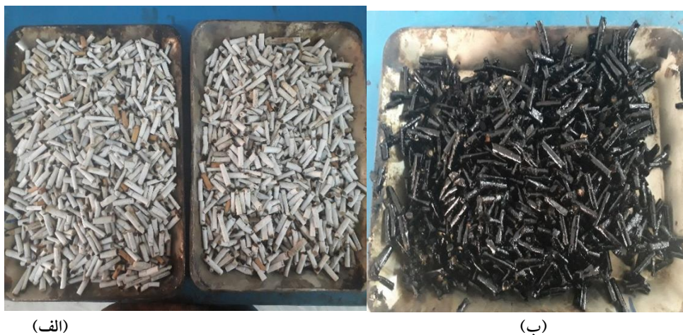
شکل ۱. فیلتر سیگار مورد استفاده در ساخت نمونه‌های آسفالتی: الف) قبل از اختلاط قیر و ب) بعد از اختلاط قیر
