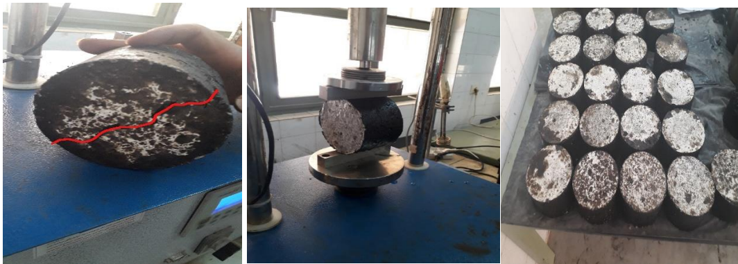
شکل ۲. نحوه شکست نمونه‌های آسفالتی به وسیله دستگاه کشش غیرمستقیم
