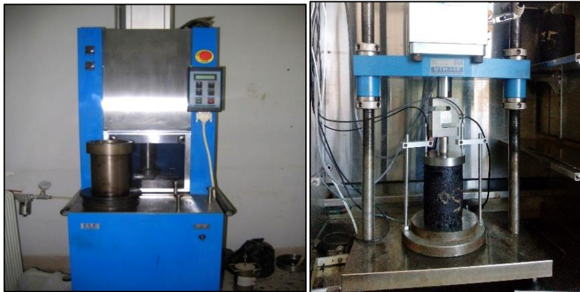
شکل ۵. دستگاه متراکم‌کننده چرخشی مورد استفاده برای ساخت نمونه‌ها (راست) و دستگاه آزمایش چندکاره مورد استفاده در آزمایش خزش (چپ)
