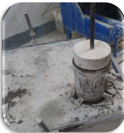
شکل ۱. نمونه استوانه‌ای تحت سربار روی میز ارتعاش
