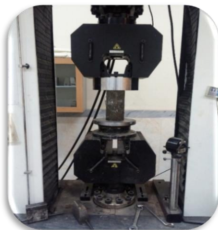
شکل ۲. نحوه قرارگیری نمونه در دستگاه اندازه‌گیری مقاومت فشاری
