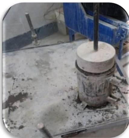
شکل ۱. نمونه استوانه‌ای تحت سربار روی میز ارتعاش
