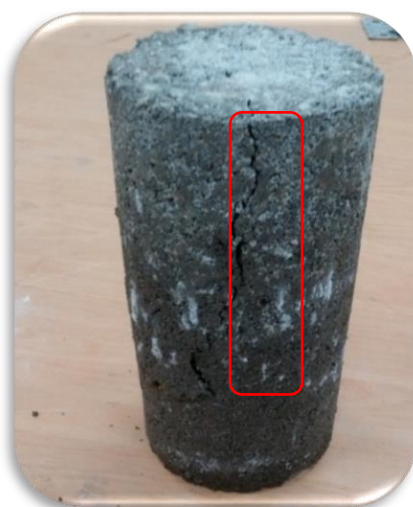
شکل ۴. نحوه گسترش ترک در نمونه‌های مقاومت فشاری
