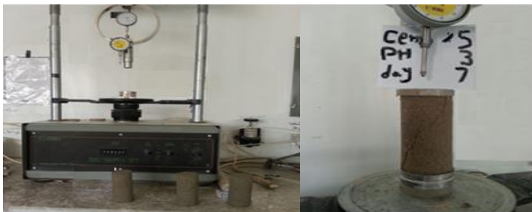
شکل ۸. دستگاه تک‌محوری (سمت چپ) و نمونه استوانه‌ای خاک تثبیت شده با ۰.۵٪ سیمان (سمت راست)
