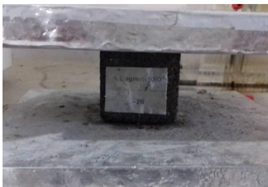
شکل ۲. اندازه‌گیری مقاومت الکتریکی نمونه مکعبی در
