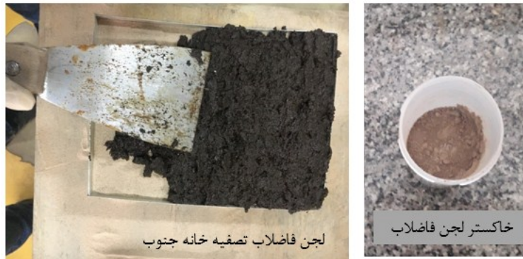
شکل ۳. لجن فاضلاب تصفیه‌خانه جنوب تهران و خاکستر حاصل از سوزاندن آن
