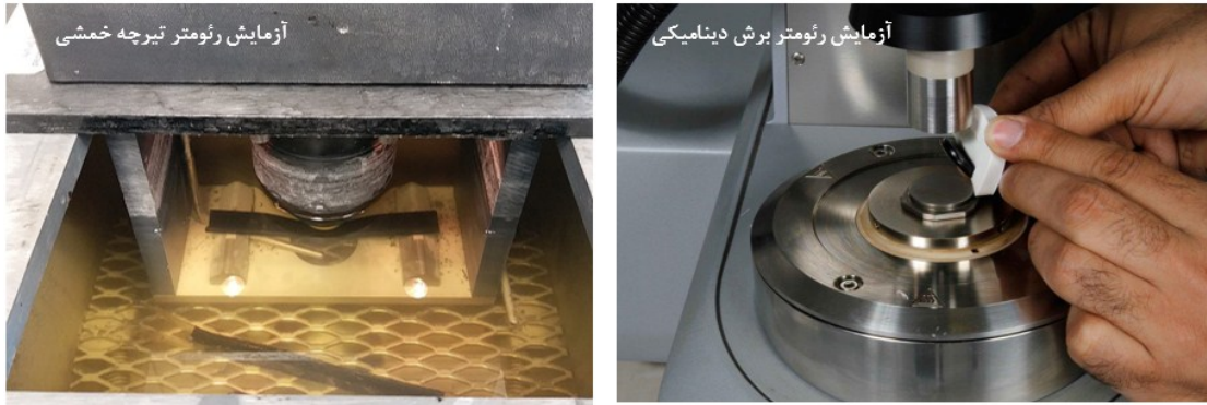
شکل ۴. تصویر آزمایش‌های رئومتر برش دینامیک و رئومتر تیرچه خمشی
