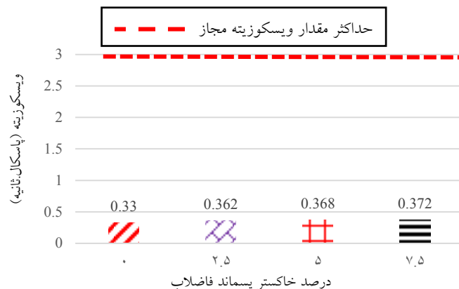
شکل ۸. تأثیر افزودن خاکستر لجن فاضلاب بر ویسکوزیته قیر در دمای ۱۳۵ °C
