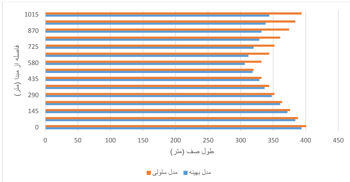
شکل ۱۲. طول صف ایجاد شده در لینک ۲ با توجه به مکان قرارگیری تابلوی پیام متغیر در هر یک از مدل‌ها
