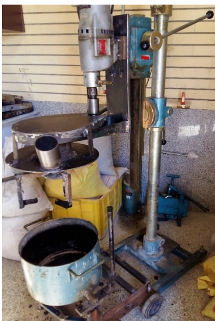
شکل ۲. جک هیدرولیکی و قالب تراکم دال‌های آسفالتی (سمت راست) میکسر آسفالت (سمت چپ)
