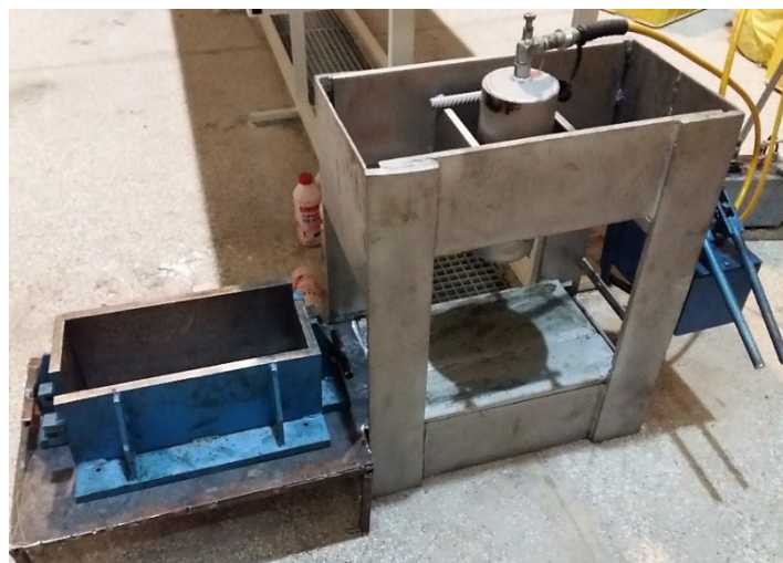
شکل ۲. جک هیدرولیکی و قالب تراکم دال‌های آسفالتی (سمت راست) میکسر آسفالت (سمت چپ)
