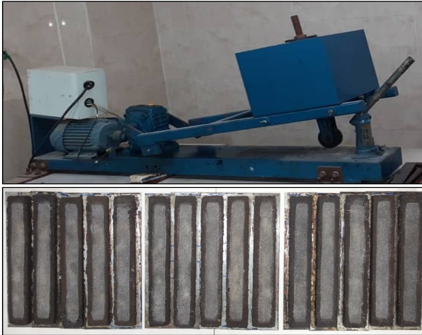
شکل ۴. دستگاه چرخ بارگذاری و نمونه‌های این آزمایش بعد از اعمال بارگذاری
