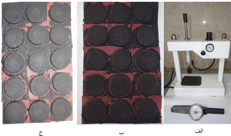
شکل ۲. الف- نمایی از دستگاه آزمایش چسبندگی، ب- نمونه‌ها بعد از عمل‌آوری و قبل از آزمایش و ج- نمونه‌ها بعد از آزمایش چسبندگی
