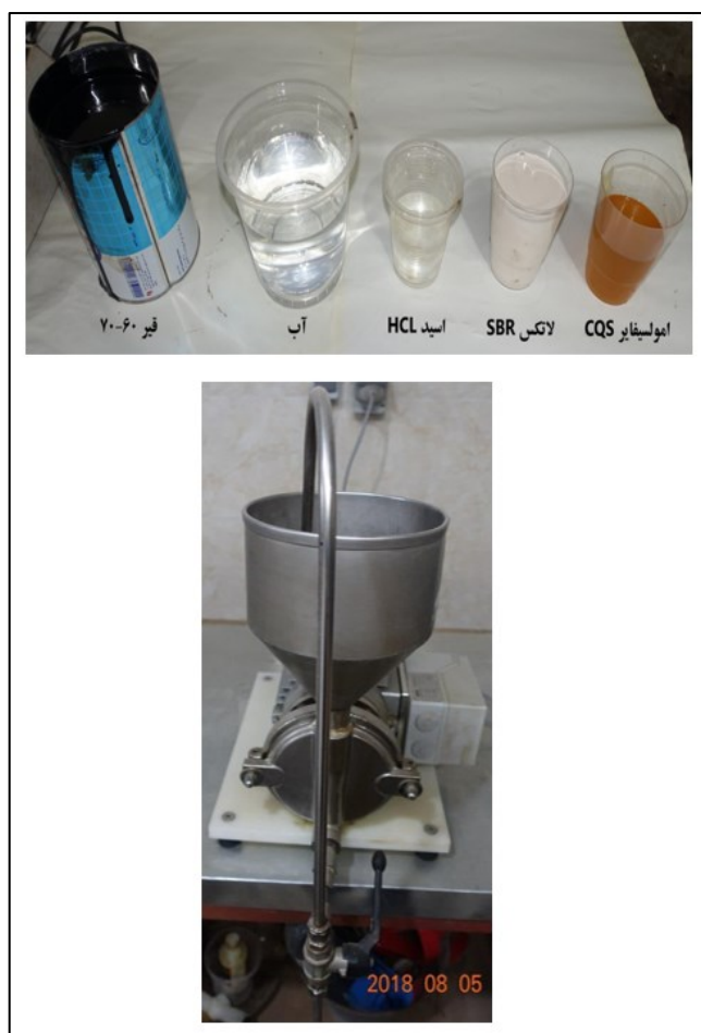
شکل ۱. مصالح مصرفی جهت تهیه قیر امولسیون پلیمری و دستگاه امولسیون ساز آزمایشگاهی
