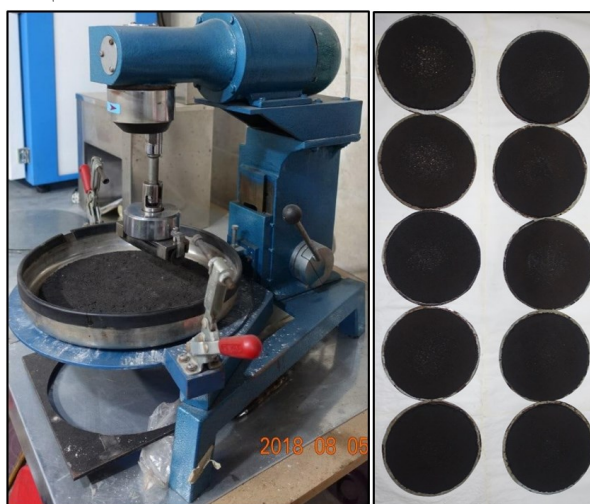
شکل ۳. نمایی از دستگاه آزمایش WTAT و نمونه‌های ساخته شده این آزمایش
