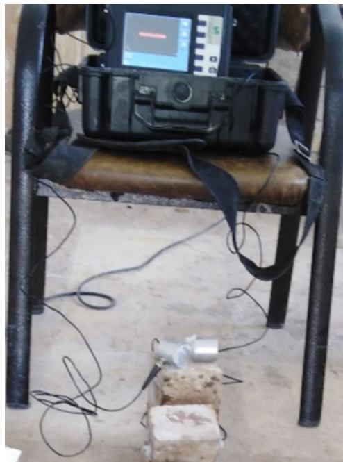
شکل ۳. دستگاه UPV و نمونه‌های بتنی
