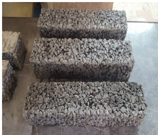
شکل ۳- الف: نمونه‌های تیری ساخته شده جهت آزمایش مقاومت خمشی در این تحقیق
