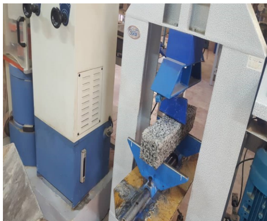
شکل ۳- ب: انجام آزمایش مقاومت خمشی در این تحقیق
