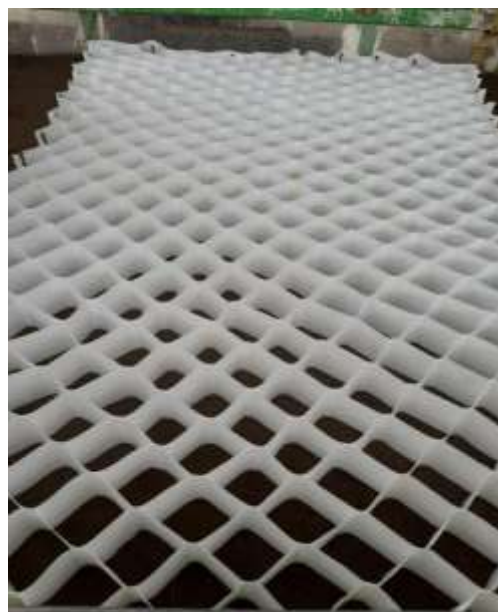
شکل ۳. ژئوسل مورد استفاده در آزمایش‌های الگو
