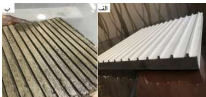
شکل ۱. الف) قالب شیاردار، ب) نمونه شیاردار با پهنای شیار ۲/۵ mm و فاصله‌ی شیار ۱۲/۷ mm
