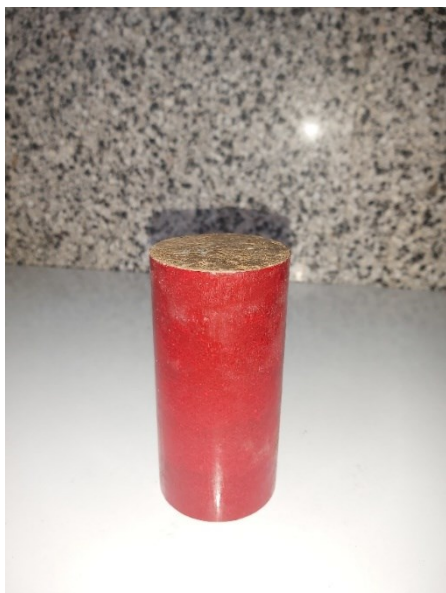
(ب) نمونه‌های خارج شده از داخل قالب به منظور انجام عمل آوری
