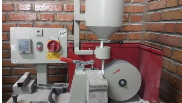
شکل ۱۲. دستگاه آزمایش مقاومت سایشی با چرخ غلتان مورد استفاده در این پژوهش
