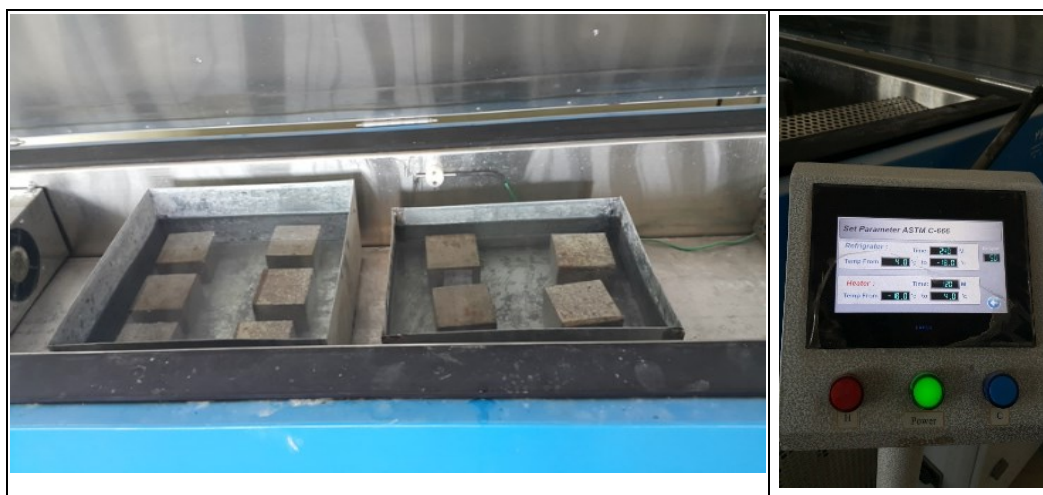
شکل ۷. مخزن دستگاه ذوب و انجماد و نحوه قرارگیری نمونه‌ها در داخل آن
