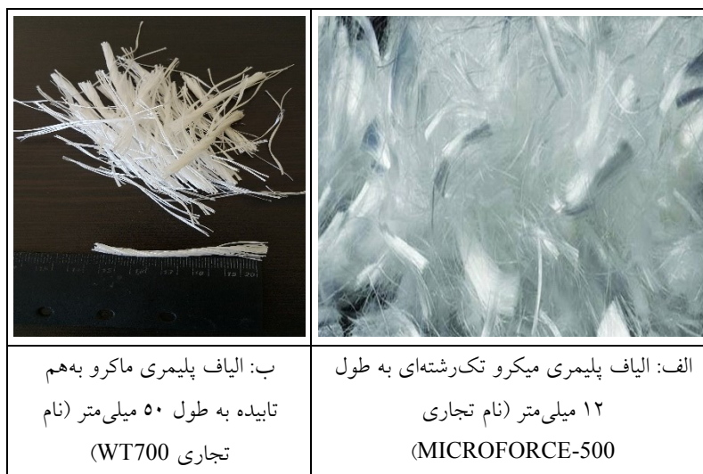
شکل ۲. دو نوع الیاف پلیمری مورد استفاده در پژوهش
