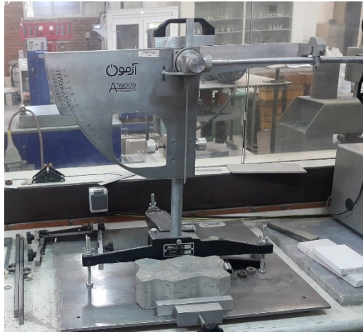
شکل ۱۰. دستگاه آزمایش آونگ انگلیسی مورد استفاده در این پژوهش
