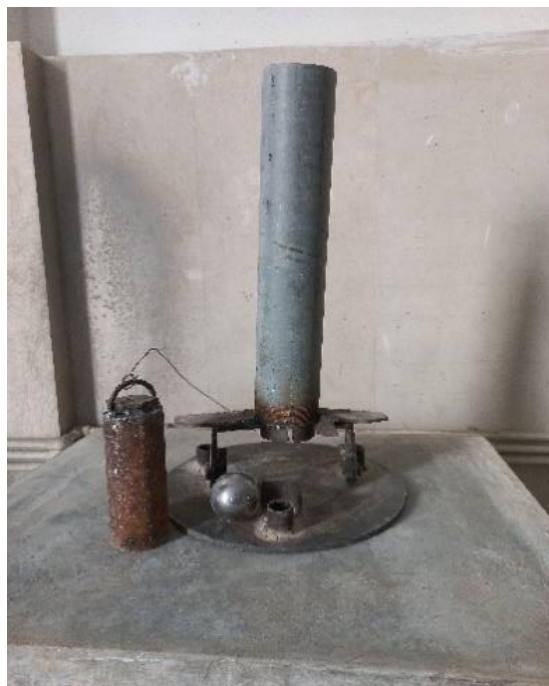
شکل ۹. دستگاه تست ضربه مطابق با استاندارد ACI544
