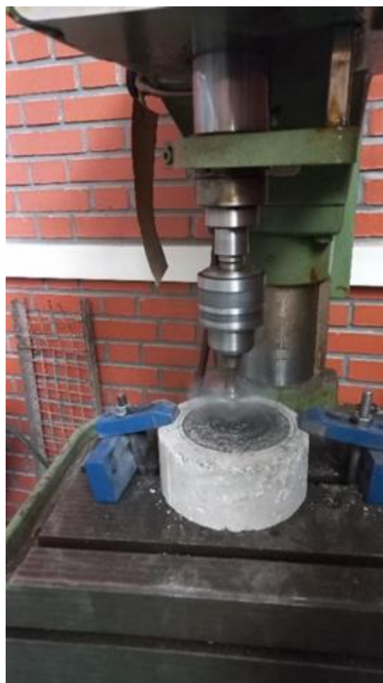
شکل ۷. دستگاه تست سایش (ASTMC944)
