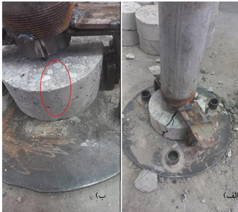
شکل ۱۶. الف) نمونه بعد از شکست تحت بار ضربه‌ای و ب) ظهور اولین ترک روی نمونه تحت بار ضربه‌ای
