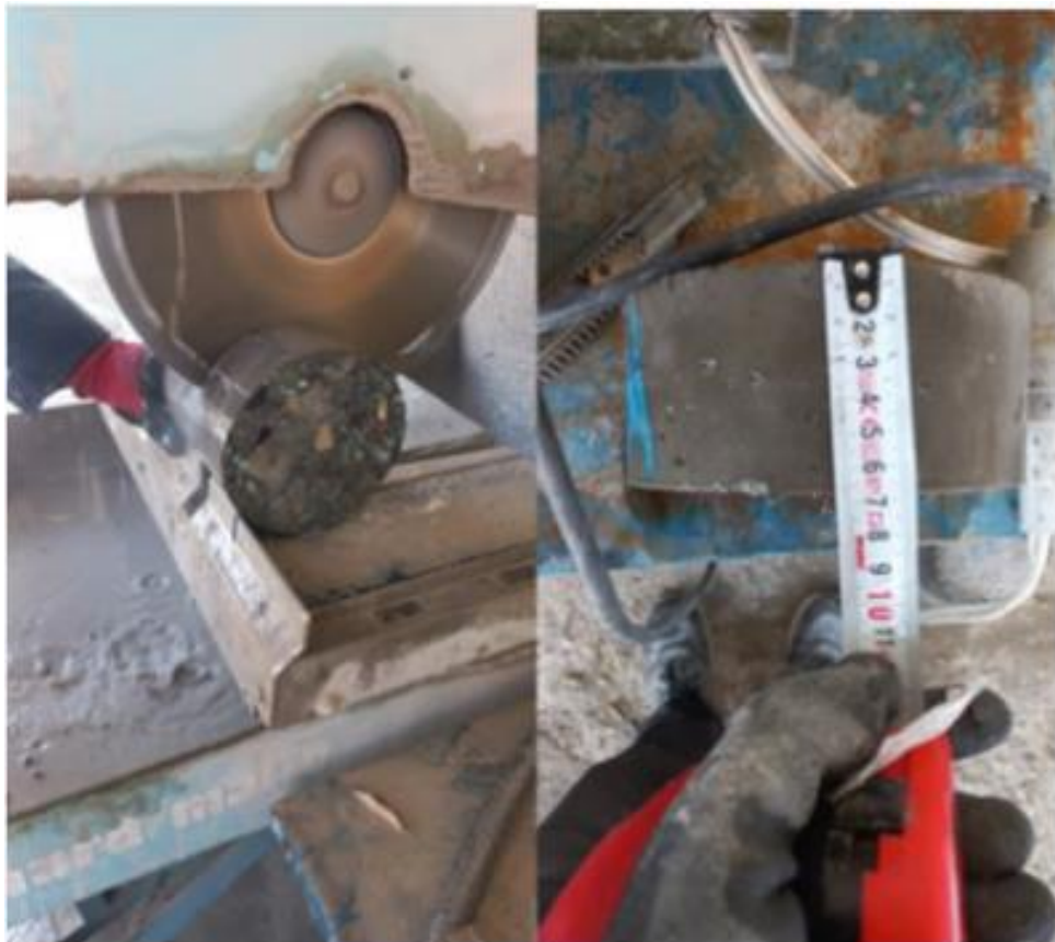
شکل ۵. برش نمونه‌های استوانه‌ای به ضخامت ۶/۴ سانتی متر
