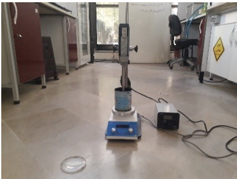
شکل ۳. مراحل اختلاط قیر با نانوسیلیس: حرارت دادن به قیر تا ۱۶۰ درجه سلسیوس و اختلاط قیر با نانوسیلیس با دستگاه هموژنایزر
