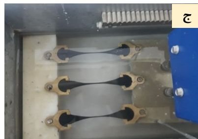
شکل ۵. الف) تعیین نقطه نرمی، ب) درجه نفوذ و ج) شکل پذیری (انگمی) قیر
