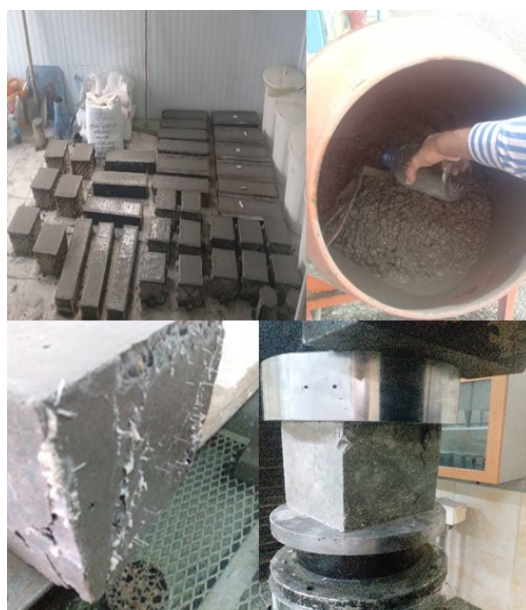
شکل ۳. مراحل انجام آزمایش‌ها شامل افزودن باکتری، قالب‌بندی و انجام آزمایش روی بتن
