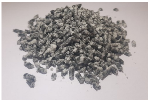
شکل ۳. الیاف سلولزی مخصوص SMA
