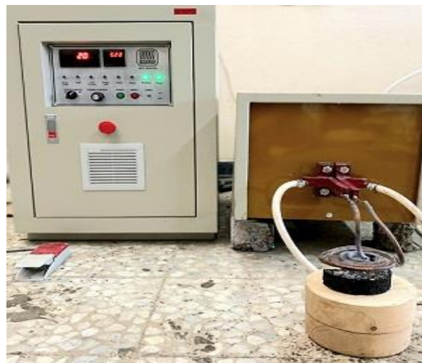
شکل ۲. دستگاه گرمایش القایی مورد استفاده در تحقیق
