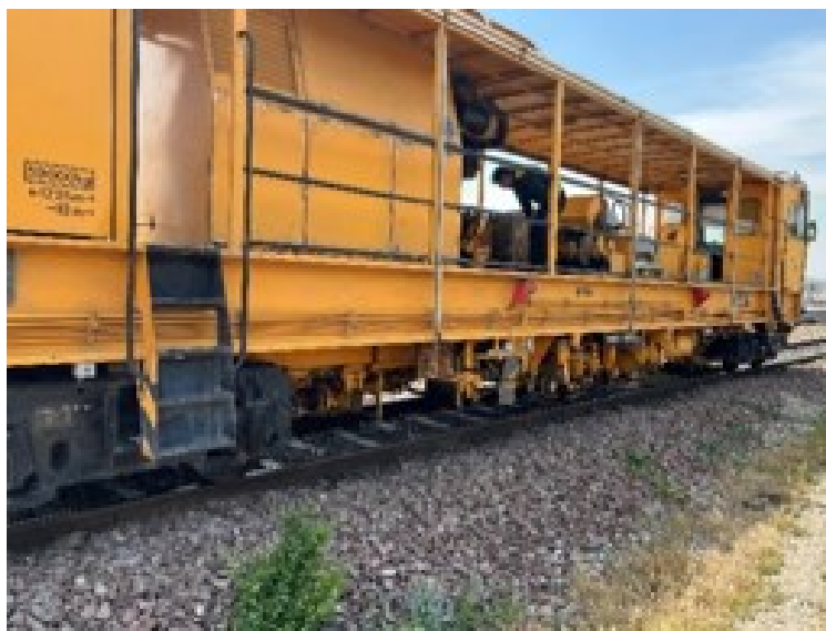
شکل ۲. ماشین پایدارساز خط
