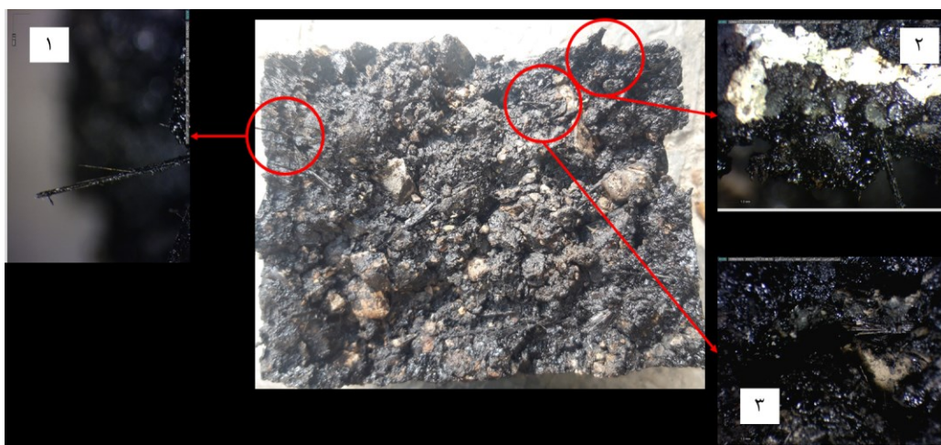
شکل ۹. الیاف در سطح مقطع ترک‌خورده نمونه در آزمایش ITS (تصاویر ۱ و ۲: ستر خوردن الیاف از درون قیر امولسیون، تصویر ۳: الیاف پوشیده شده توسط قیر امولسیون در کنار سنگدانه آهکی)
