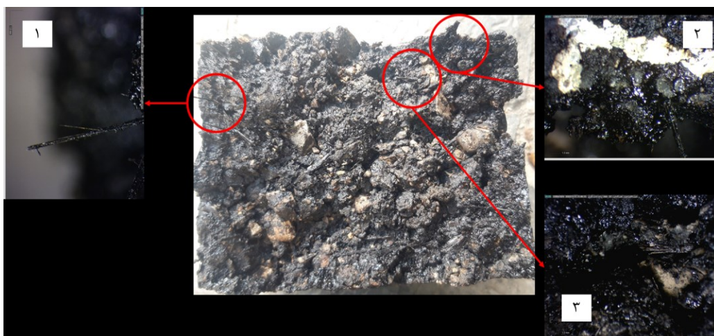
شکل ۹. الیاف در سطح مقطع ترک‌خورده نمونه در آزمایش ITS (تصاویر ۱ و ۲: سُر خوردن الیاف از درون قیر امولسیون، تصویر ۳: الیاف پوشیده شده توسط قیر امولسیون در کنار سنگدانه آهکی)
