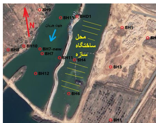
شکل ۱. جانمایی تقریبی گمانه‌های ژئوتکنیک در رودخانه و سواحل کارون
