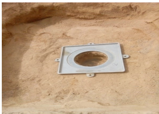
شکل ۲. نمونه‌گیری مربوط به آزمایش دانسیته در محل به روش مخروط ماسه
