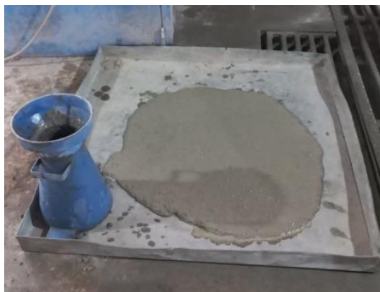
شکل ۳. آزمایش جریان اسلامپ
