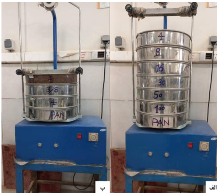
شکل ۱. الک‌های مورد استفاده به‌همراه دستگاه شیکر، (الف) الک‌های ریزدانه و (ب) الک‌های درشت‌دانه
