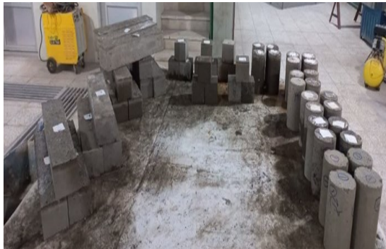
شکل ۵. نمونه‌های مکعبی، استوانه‌ای و تیر خمشی مورد استفاده در این تحقیق
