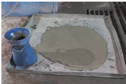
شکل ۳. آزمایش جریان اسلامپ
