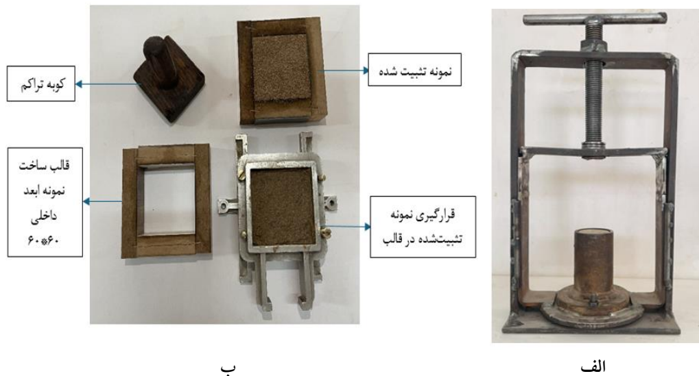
شکل ۴. تصاویری از الف) دستگاه‌های طراحی و ساخته شده ب) ساخت نمونه قالب و نمونه خاک
