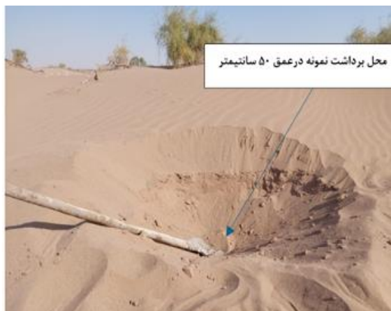
شکل ۱. دانه‌بندی و فرآیند برداشت مصالح در این پژوهش جهت ساخت نمونه‌های تثبیت شده
