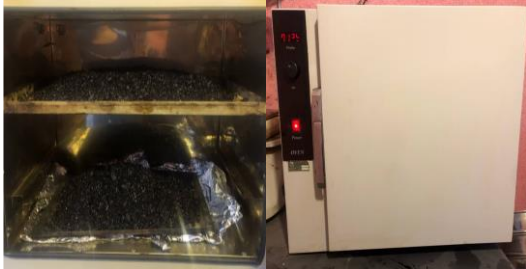
شکل ۴. اعمال پیرشدگی اولیه و دستگاه گرم‌کن آن
