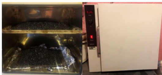
شکل ۴. اعمال پیرشدگی اولیه و دستگاه گرم‌کن آن
