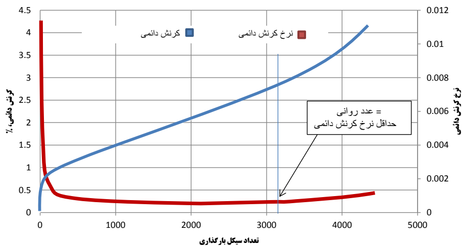
شکل ۵- تغییرات نرخ کرنش دائمی در آزمایش خزش دینامیک برای یکی از نمونه‌های SMA حاوی ۲۵٪ خرده لاستیک
