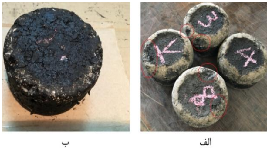
شکل ۷. نمونه‌های تخریب شده بر اثر آزمایش دوام کانتابرو: الف) قبل از اعمال گرمایش و ب) بعد از اعمال گرمایش
