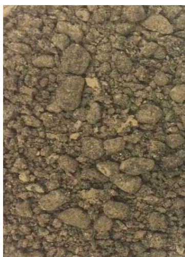
شکل ۹. مخلوط ماسه آسفالت بدون افزودنی
