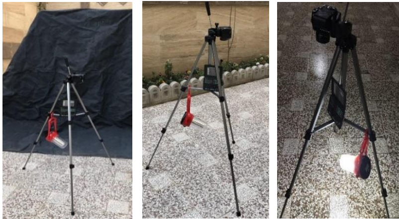
شکل ۱. سخت افزار برداشت تصاویر خرابی روسازی آسفالتی در شرایط کنترل شده
