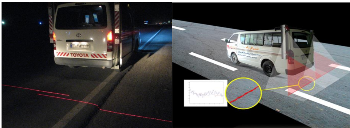
شکل ۱. خودروی تجهیز شده جهت برداشت داده‌های خرابی رویه راه
