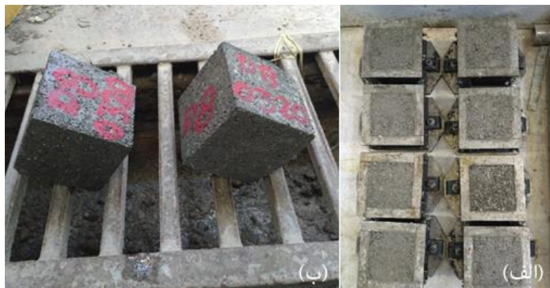
شکل ۳. فرایند ساخت نمونه ها؛ الف) نمونه های RCCP متراکم شده و ب) نمونه خروجی حوضچه عمل آوری
