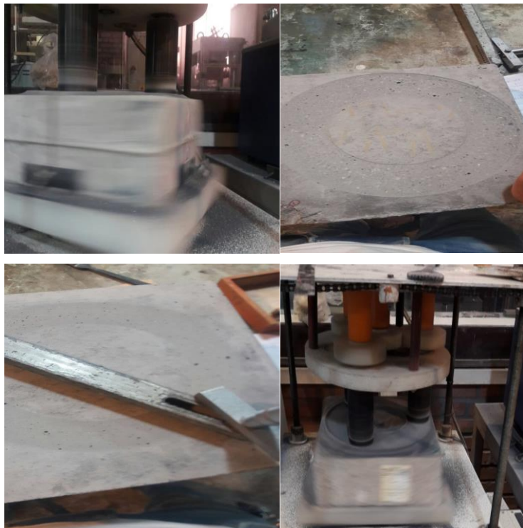
شکل ۵. نحوه‌ی انجام و اندازه‌گیری مقاومت سایشی بتن طبق استاندارد ASTM C779- A
