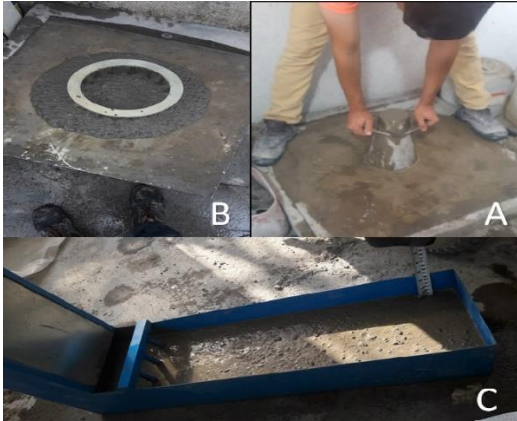
شکل ۲. تصاویر A، B و C به ترتیب آزمایش جریان اسلامپ، جریان اسلامپ در حلقه J و آزمایش جعبه L
