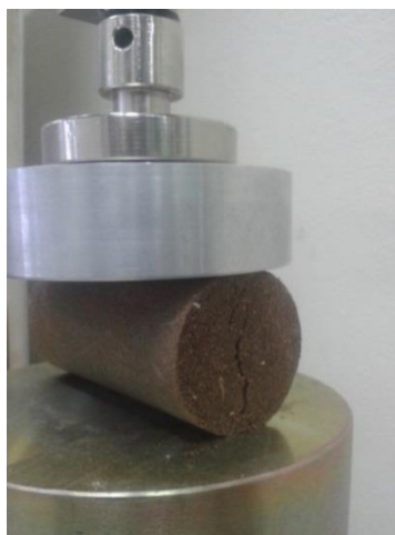
شکل ۵. نحوه قرارگیری نمونه جهت انجام آزمایش کشش
