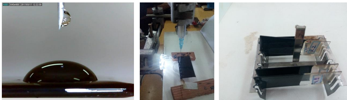
شکل ۱. آزمایش قطره چسبنده برای اندازه‌گیری انرژی آزاد سطحی
