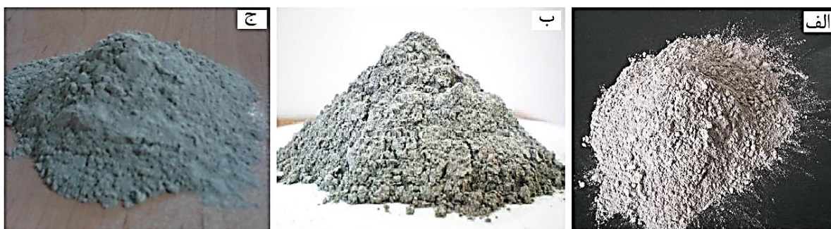
شکل ۲. الف) سرباره کوره آهن‌گدازی، ب) خاکستر بادی و ج) غبار کوره سیمان
